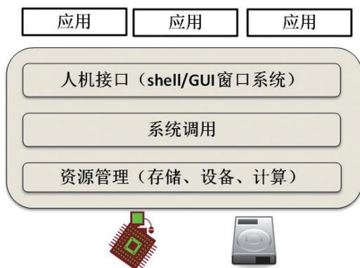
图2 操作系统结构的3个层次
